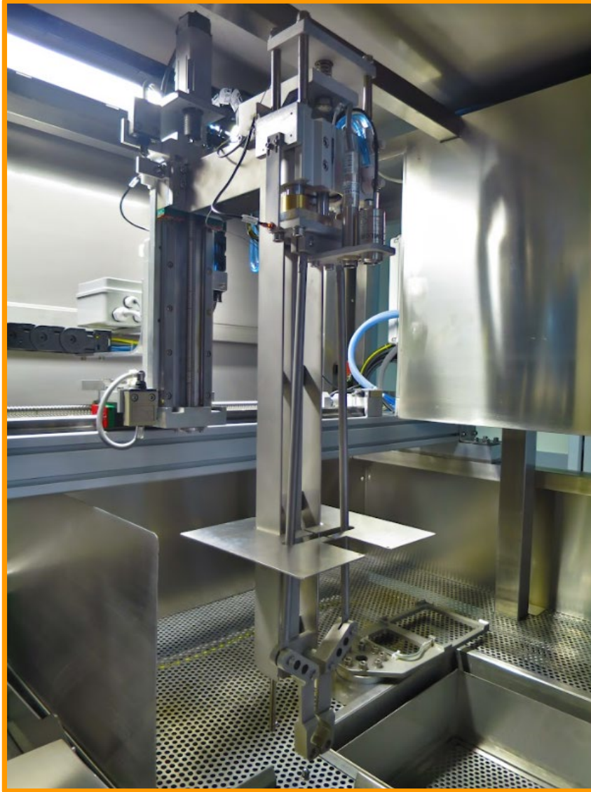
Dettaglio sistema di movimentazione SiC in bagno di KOH
